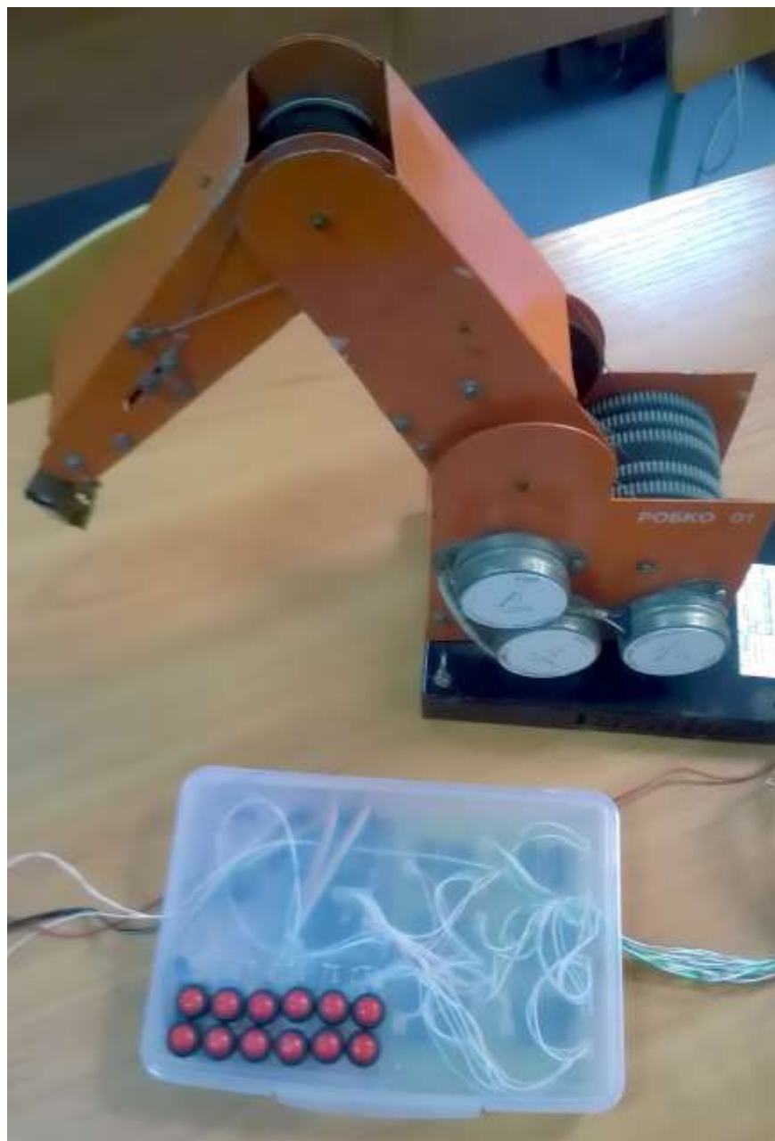
Фигура 5. Завършения вид на експерименталната установка и интерактивен модел на устройство за управление на Българският робот РОБКО-01 заедно с робота
