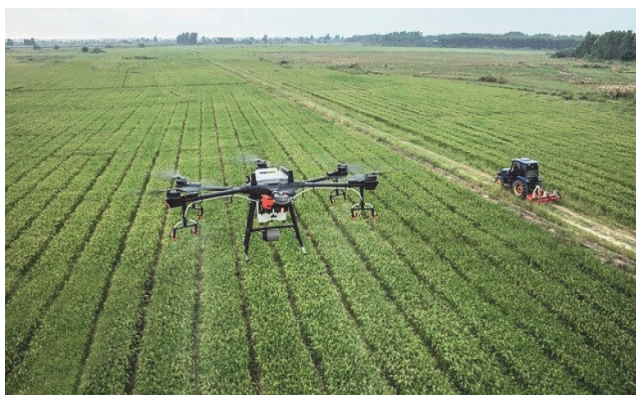
Фиг. 10. Дрон за спектрални изследвания на земеделски площи
