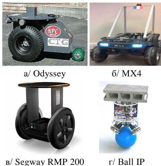
Фиг. 2. Конвенционални и новоразвивани мобилни роботи с динамична устойчивост: а/ триколесен диференциален робот; б/ класически четириколесен; в/ двуколесен и г/ едноколесен балансиращ робот.
