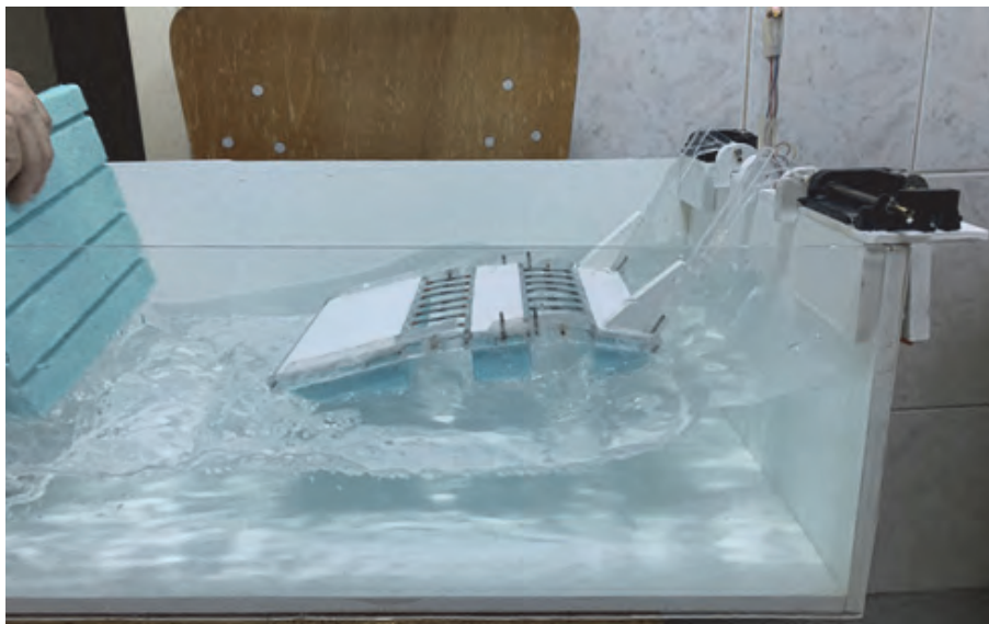
Фиг. 17. Действащ макет на проектирания вълнов преобразувател.
