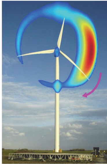
Фиг. 2. Местоположение и количествено определяне на източниците на шум от вятърна турбина
