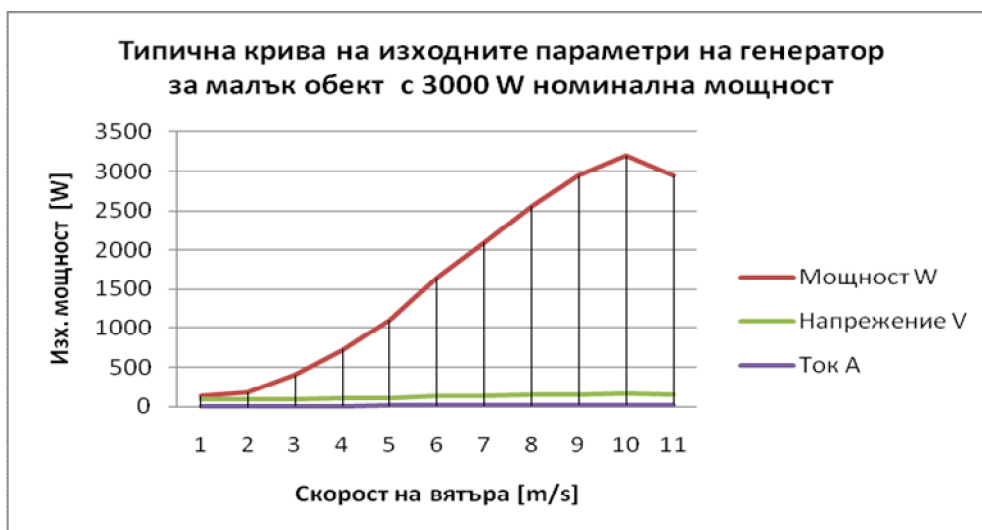
Фиг.3 Изходна мощност на 3 KW генератор като функция на скоростта на вятъра
