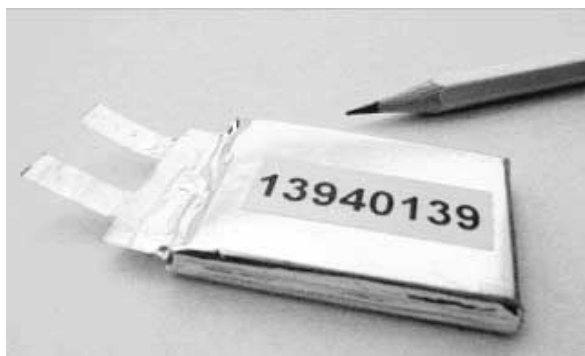
Фиг. 4. Компактна батерия тип „кесия“
