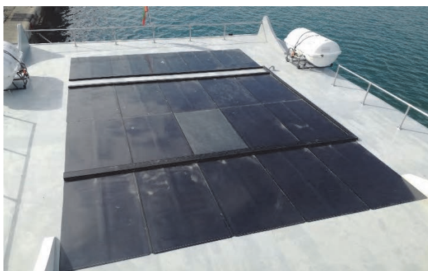
Фиг. 9. Слънчеви панели монтирани на катамарана
