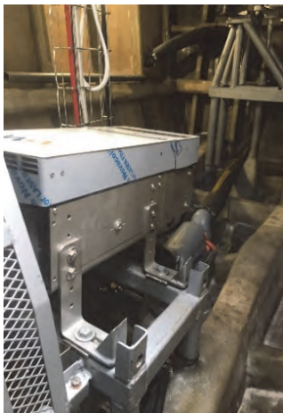
Фиг. 11. Задвижване на катамарана – Асинхронни двигатели, инвертори и тягова акумулаторна батерия.
