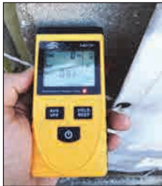
Фиг. 2. Показания на уреда Benetech GM3120 на разстояние 10 cm от трансформатора
