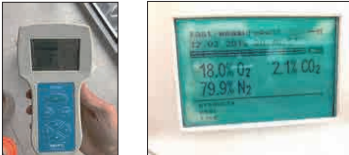
Фиг. 5. Измерване на количеството на отделените от маслото газове с газанализатор ОХУВАВУ 6.0 O 2 /CO 2
