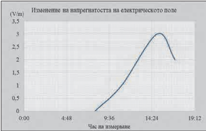
Фиг. 4. Изменение на интензитета на електрическото поле в зависимост от времето на измерване
