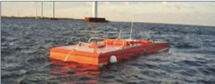
Фиг. 10. Crestwing, в мащаб 1: 5, тестван близо до Frederikshavn през есента на 2011 г.
