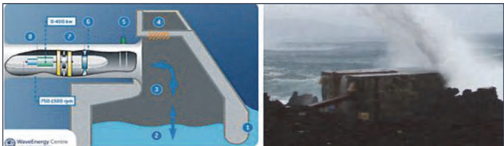
Фиг. 6. Pico OWC – схема и действаща инсталация.
