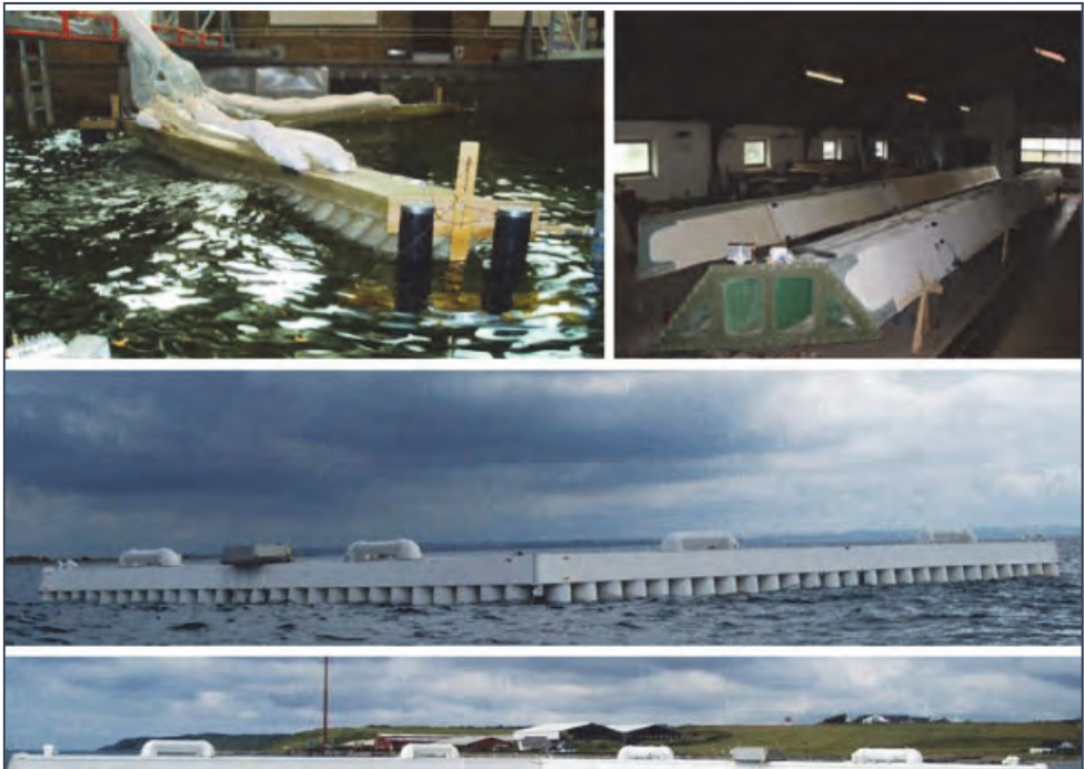
Фиг. 8. Модел LeanCon в мащаб 1:40: модел в басейн (горе, вляво), прототип 1:10 за тестване в Nissum Bredning, Дания, в процес на изграждане (горе, вдясно) и след разполагане (средна и отдолу).
