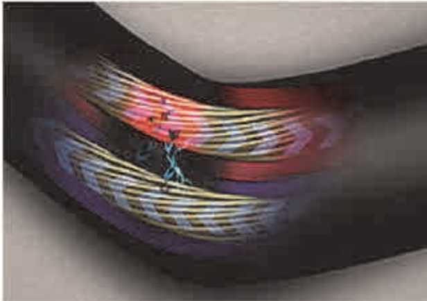
Късо съединение между паралелни проводници
