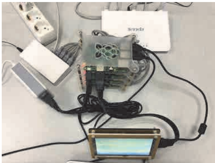
Фиг. 6. Компютърен клъстер на база едноплаткови компютри
