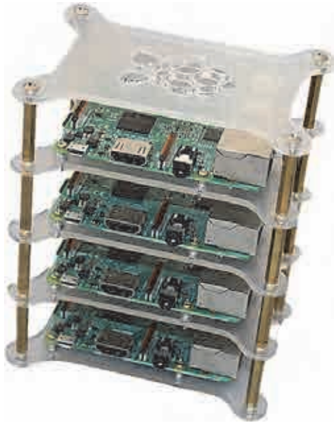
Фиг. 2. Модул от 4 едноплаткови компютри Raspberry Pi 3
