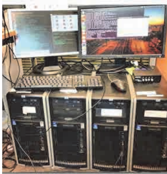
Фиг. 4. Компютърен клъстер на база персонални компютри
