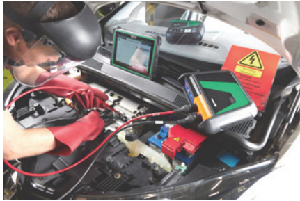
Фиг. 9. Измерване на напреженията след диагностика
