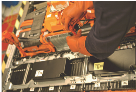
Фиг. 10. Общ вид на шините на тягов акумулатор
