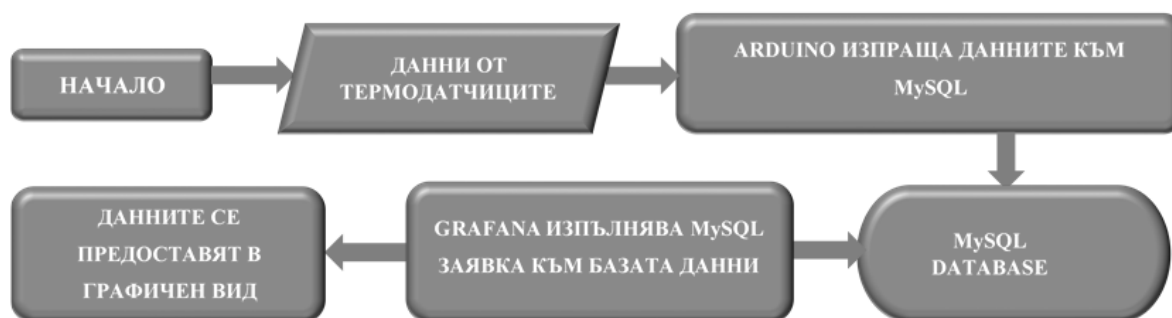
Фиг. 14. Блок-схема на алгоритъм за визуализация на данни, постъпващи от Arduino.
