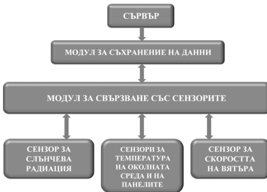
Фиг. 11. Блок схема на системата за мониторинг.
