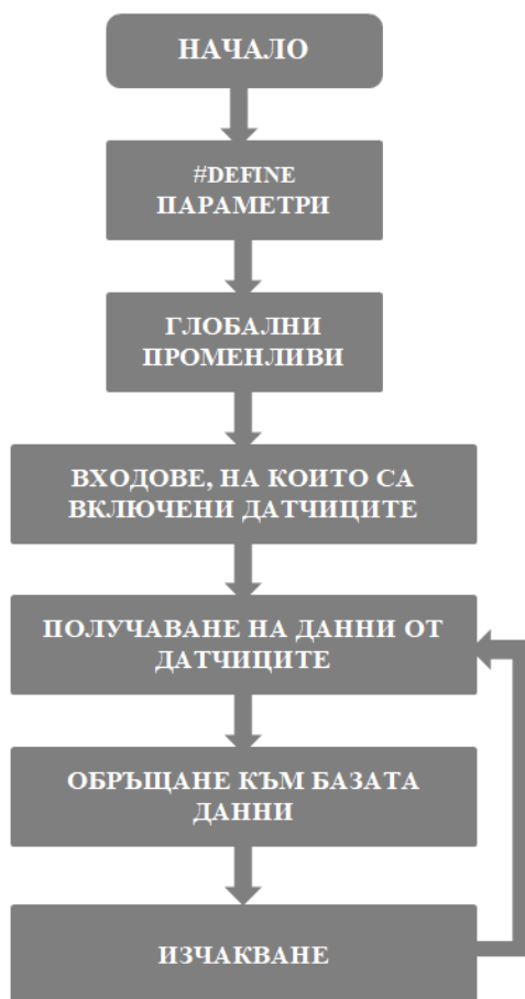
Фиг. 10. Блок схема на програмния код.
