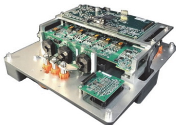
Фиг. 1. Тягов инвертор - външен вид
