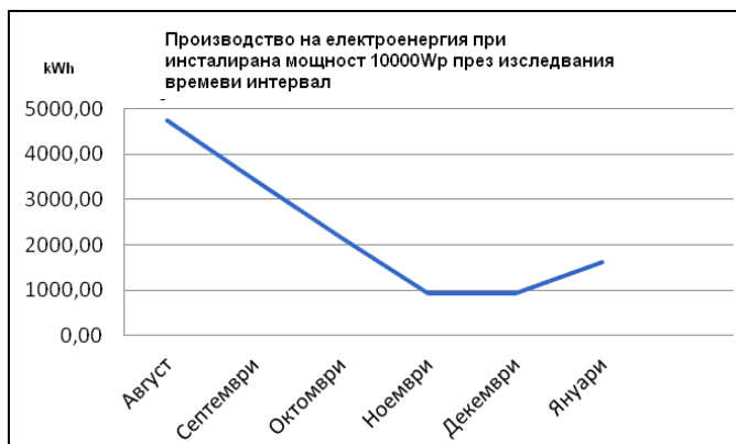
Фиг. 5. Производство на електроенергия при използване на пълната площ на покривното пространство на ниво 2-ри етаж на сградата на БСУ за изследвания период от време
