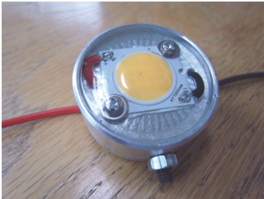
Фиг. 19. Източник на светлина – LED Array с мощност 20W
