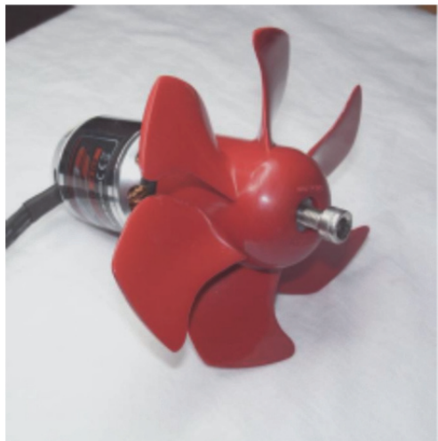
Фиг. 15. Двигател Turnigy Aerodrive и пропелер Vetus
