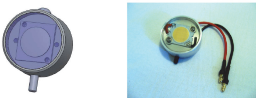
Фиг. 6. Проект и изпълнение на LED Arrays светлини за робота
