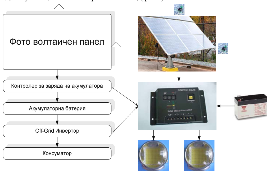
Фиг. 1. Устройство на фотоволтаична тракерна система
