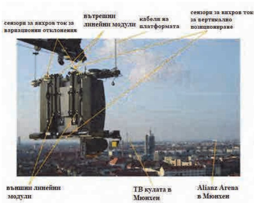
Фиг. 8. Кинематични и навигационни сензори
