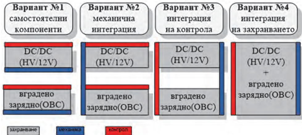
Фигура 2: Четири от най-често срещаните варианти за комбинирана архитектура на OBC и DC/DC (комбиниран блок-схеми за задвижване)
