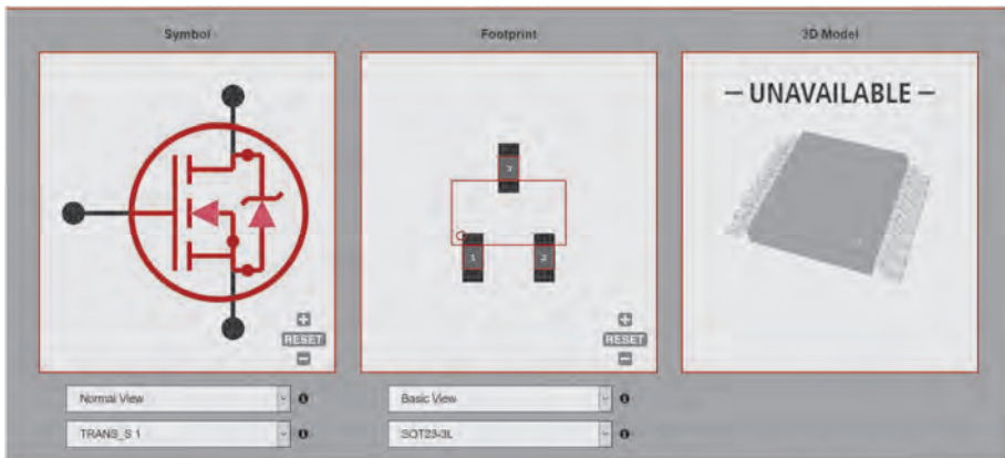
Фигура. 1. MOSFET транзистор 2N7002 с графично означение и избран корпус на компонента препоръчан от Ultra Librarian [1]
