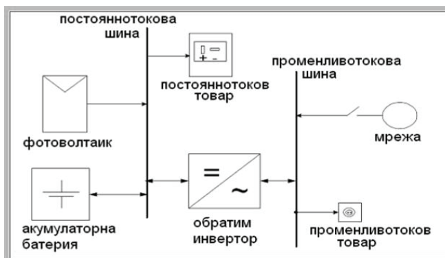
Фиг. 4. Блокова схема на примерна фотоволтаична инсталация свързана с електрическата мрежа
