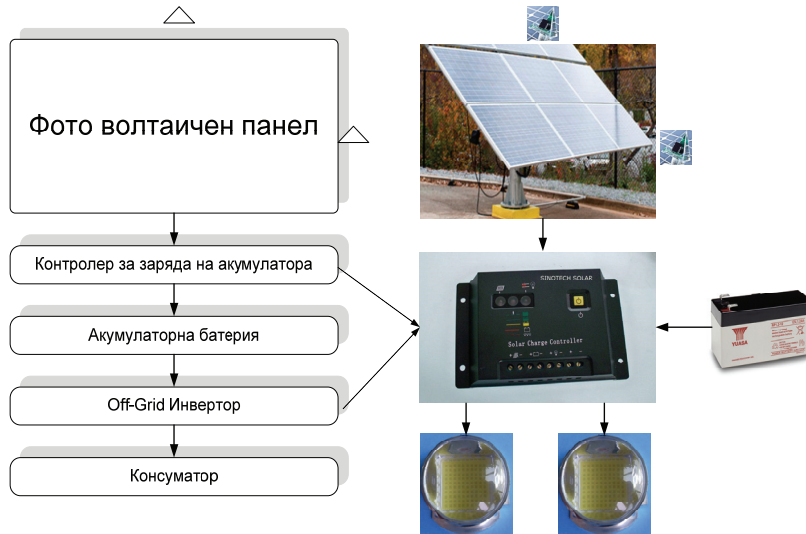
Фигура 14. Устройство на фотоволтаична тракерна система захранваща консуматор
