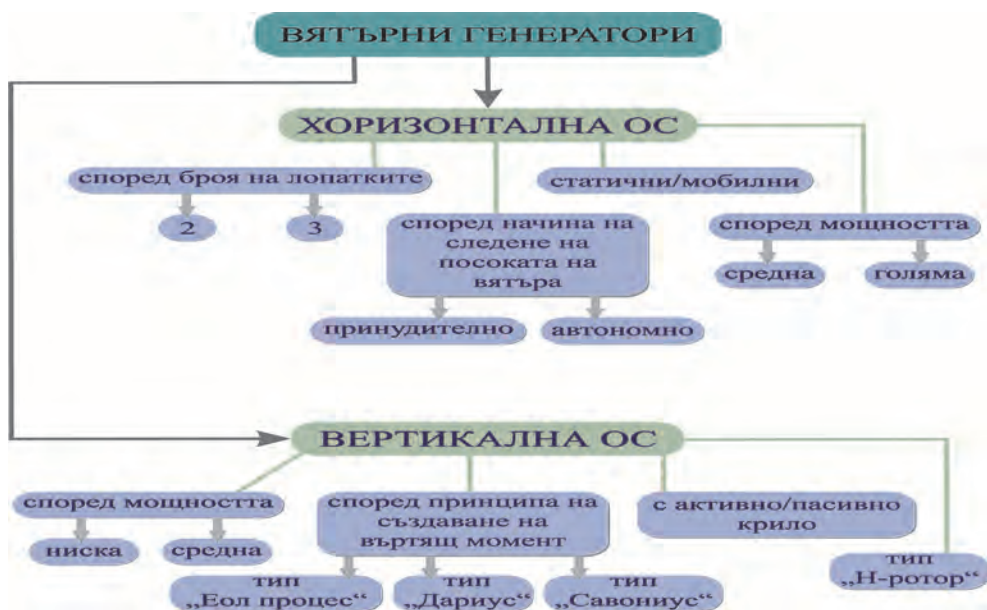
Фиг. 2. Класификация на видовете вятърни турбини
