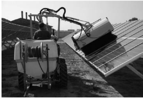
Фиг. 2. Почистване на фотоволтаичен елемент
