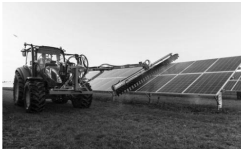
Фиг. 4. Система за почистване с използване на вода под налягане
