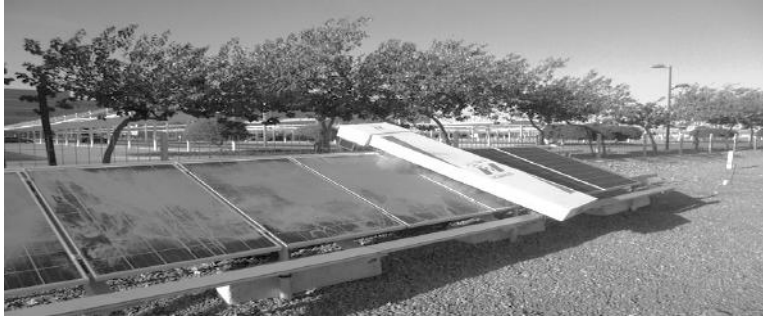
Фиг. 15. Робот за почистване на соларни ферми без вода
