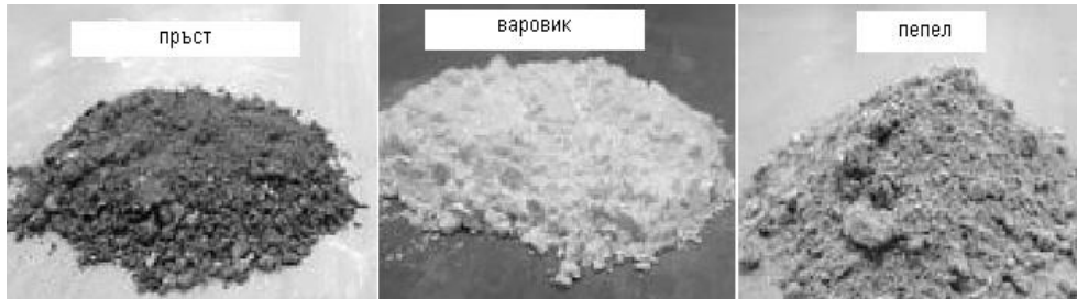
Фиг. 5. Тип на отложените замърсители на фотоволтаичните модули
