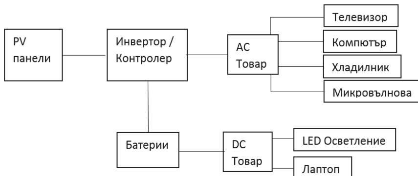
Фигура 4. Схема на малка PV система
