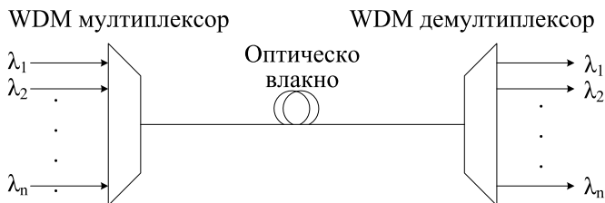
Фиг.10. Схема на оптически сегмент, използващ предаване на мултиплексен сигнал по оптично влакно
