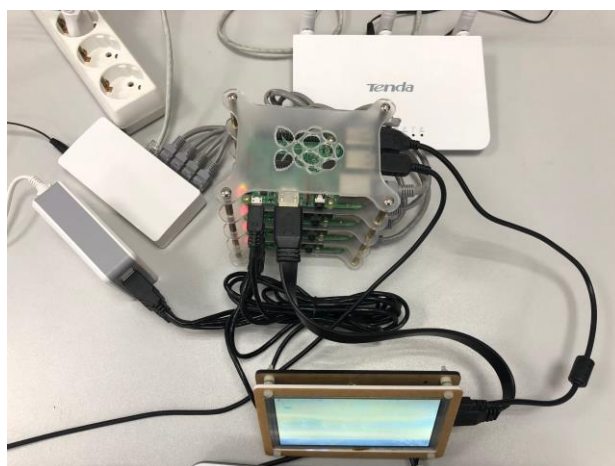
Фиг. 6. Компютърен клъстер на база едноплаткови компютри
