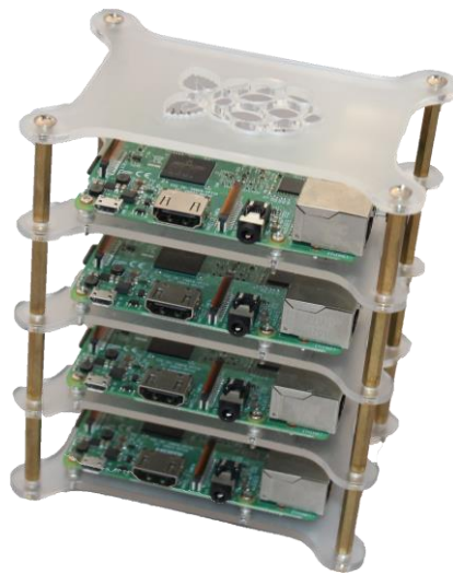
Фиг. 2. Модул от 4 едноплаткови компютри Raspberry Pi 3
