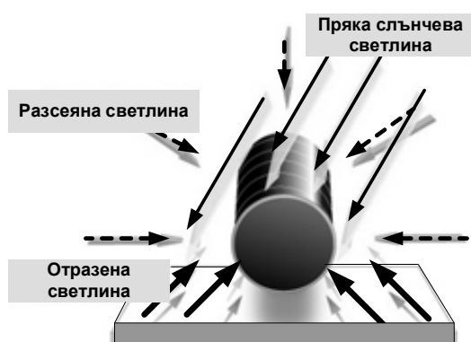
Фиг. 3. Цилиндричен фотоволтаичен панел.
