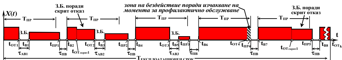
фиг. 3 Времедиаграма на блокова стратегия за техническо обслужване, с възстановявания, чийто обем зависи от момента на настъпване на отказа, без строго спазване на T_{PP}
