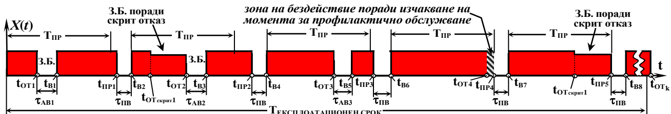
фиг. 6 Времедиаграма на блокова стратегия за техническо обслужване зависеща от момента на настъпване на отказа, с пълни аварийни възстановявания, без строго спазване на T_{PP}
