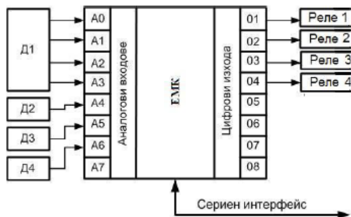
Фиг. 7. Структурна схема на електронна система за автоматично насочване на фотоволтаичен панел
