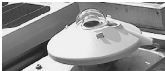
Фиг. 1. Устройство за измерване на сумарния поток слънчева радиация със защитно стъклено калпаче
