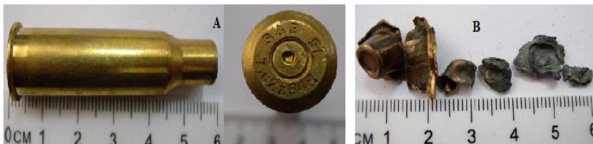
Фиг. 11. Общ вид на предоставената за изследване изстреляна гилза (А) и общ вид на фрагментите от ризница и сърдечник на предоставения за изследване изстрелян куршум (В).
