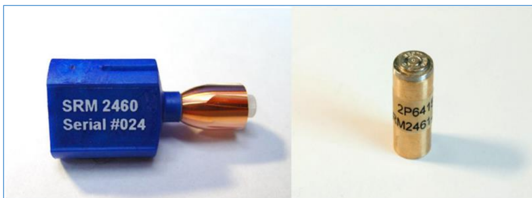
Фиг. 7. Стандартен куршум SRM2460 (вляво) и стандартен патрон SRM 2461 (вдясно).
