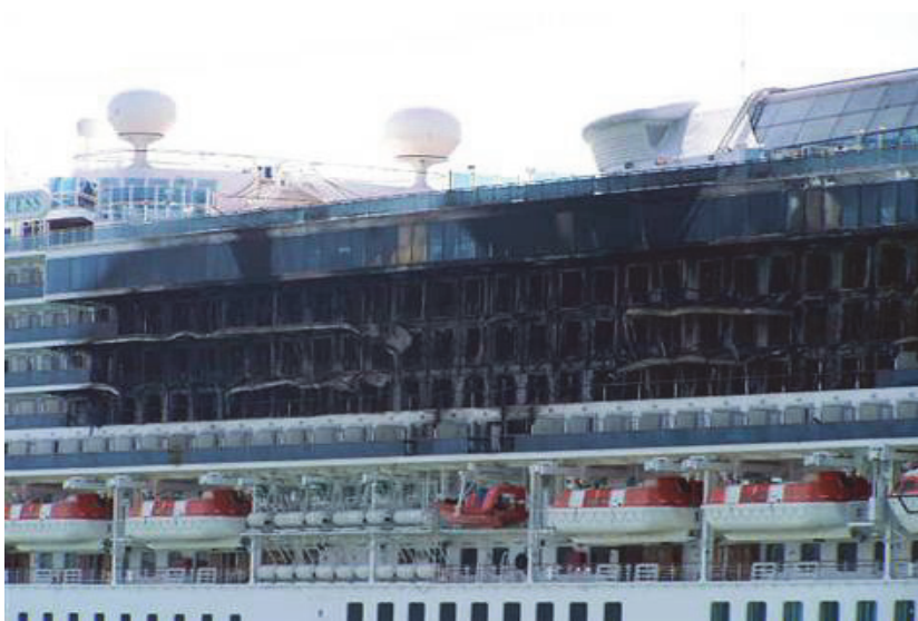
Фиг. 3. Снимка на кораба Star Princess – огънят е започнал от изхвърлена цигара, която попада на тераса и подпалва хавлия
