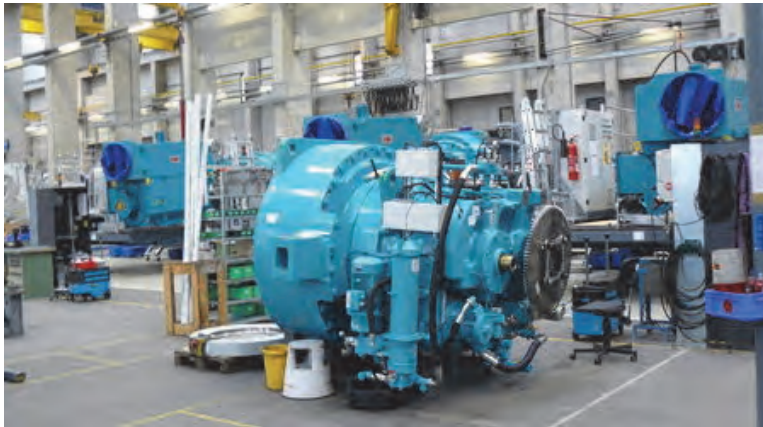
Фиг. 13. Скоростна кутия (мултипликатор)
