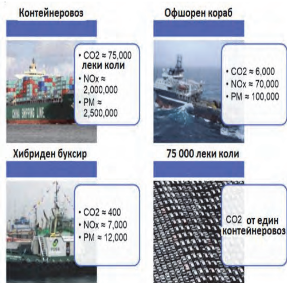
Фиг. 2. Количества на вредните емисии (NO x ; SO x ; CO 2 и твърди частици PM) на 75 000 леки автомобили, в сравнение с еквивалентните емисии на един плавателен съд.
