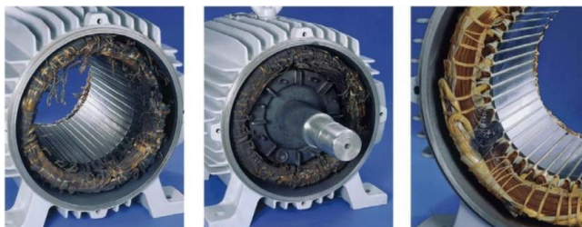
Фиг.1. Пробиви на изолацията на намотките на статора на АД.
