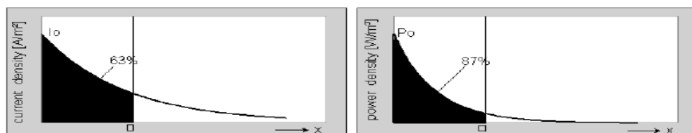
Фиг.1. Дълбочина на проникване на тока
